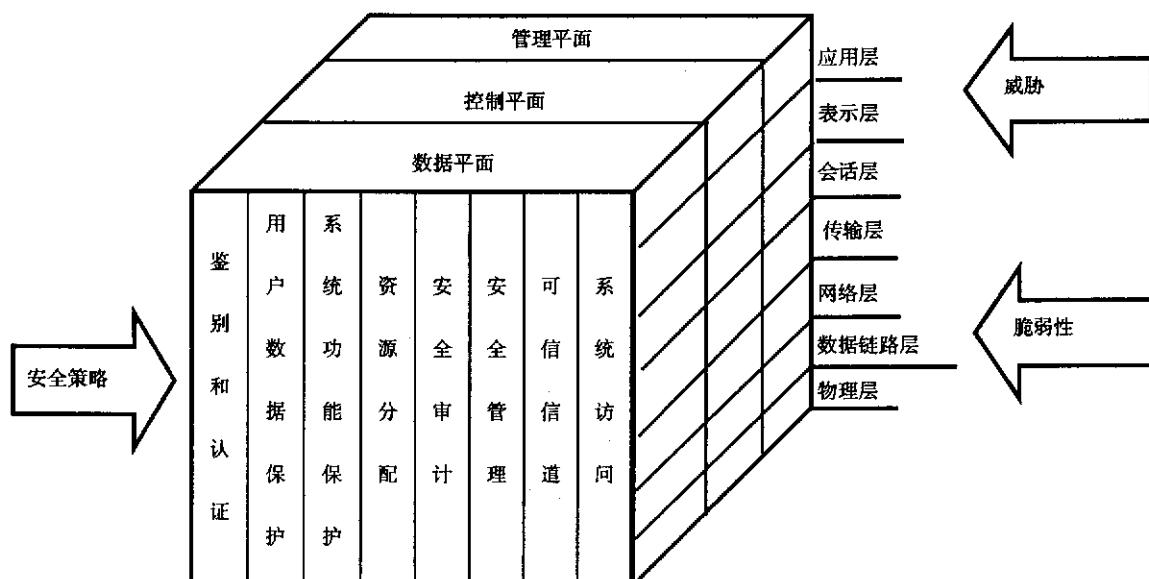
图 1 以太网交换机设备安全框架
